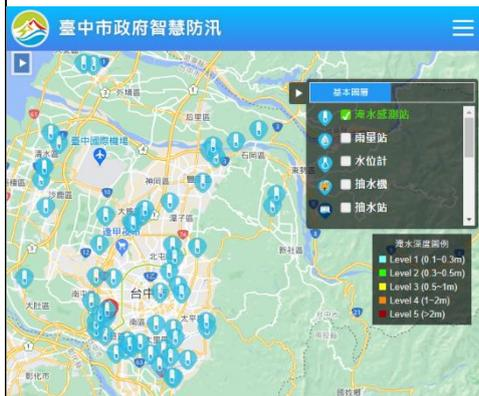
268處路面淹水感測器，架設於易淹水區域之電桿或燈桿上，可偵測完整淹水及退水歷程，訊號透過 NB-IOT 通訊方式回傳感測資訊至系統平台，全天候 24小時監測，達警戒值時發布告警通知。
