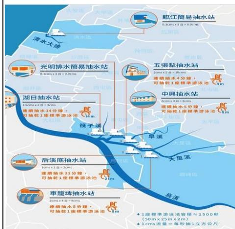
建置5處固定式抽水站、2處簡易式抽水站及31部移動式抽水機訊號監測，訊號透過 NB-IOT 通訊方式回傳感測資訊至系統平台，可即時取得抽水機馬達啟動、抽水、待命及 GPS 坐標狀態。
