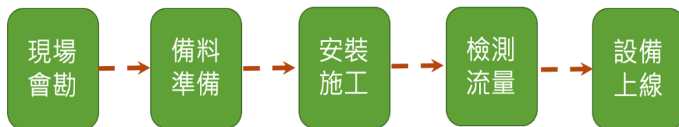
圖7、計量設備裝設程序圖
