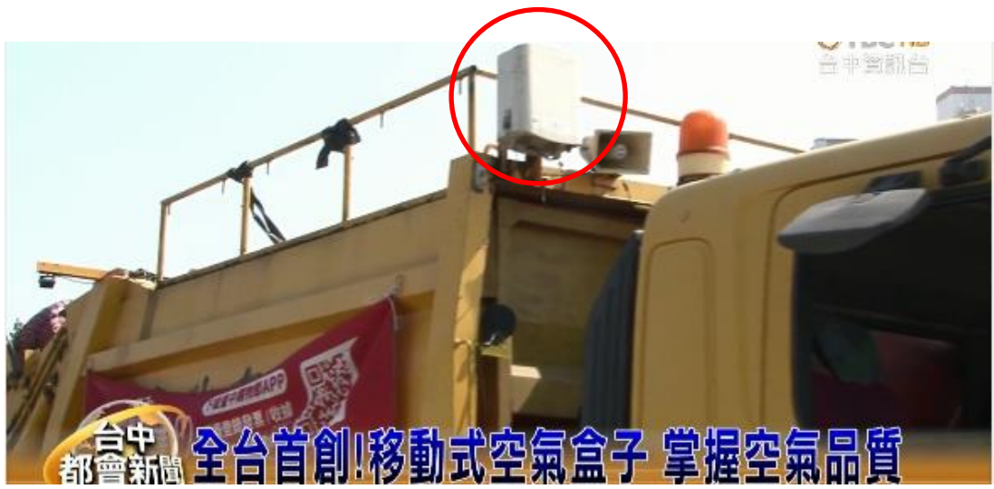
↑圖紅線處為垃圾車上加裝之空氣微型感測器
