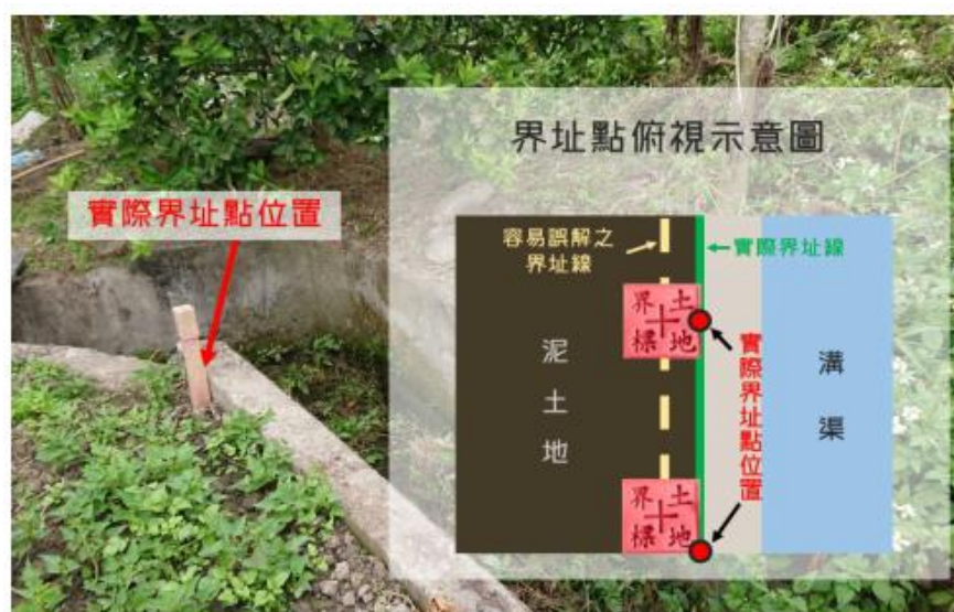
圖一：界址點與界標指示位置不符狀況示意圖-狀況一
