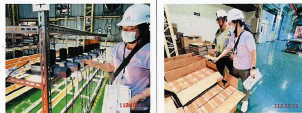
照片 2(抽驗 LED 智慧型燈具功能正常運作，數量 60 只，尚符契約規範)
