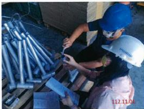
照片 3(抽測燈桿與燈具轉接桿，桿件長邊之管徑厚度 3mm，尚符契約規範)
