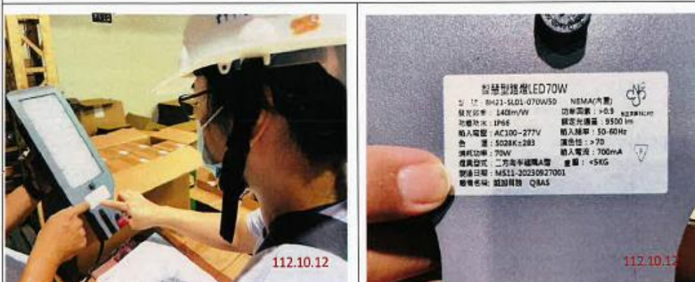
照片 3【抽驗 LED 智慧型燈具規格(發光效率 140lm/w、防塵防水 IP66、色溫 5028K+283)，尚符契約規範】
