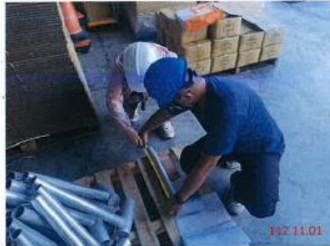
照片 1(抽測燈桿與燈具轉接桿，桿件長邊之長度 48.6cm，尚符契約規範)
