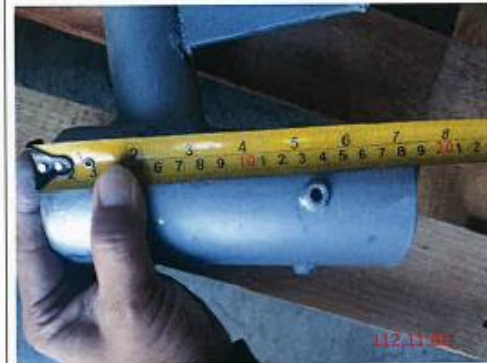
照片 2(抽測燈桿與燈具轉接桿，桿件短邊之長度 18.1cm，尚符契約規範)
