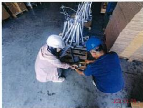
照片 2(抽測燈桿與燈具轉接桿，桿件短邊之長度 18.1cm，尚符契約規範)
